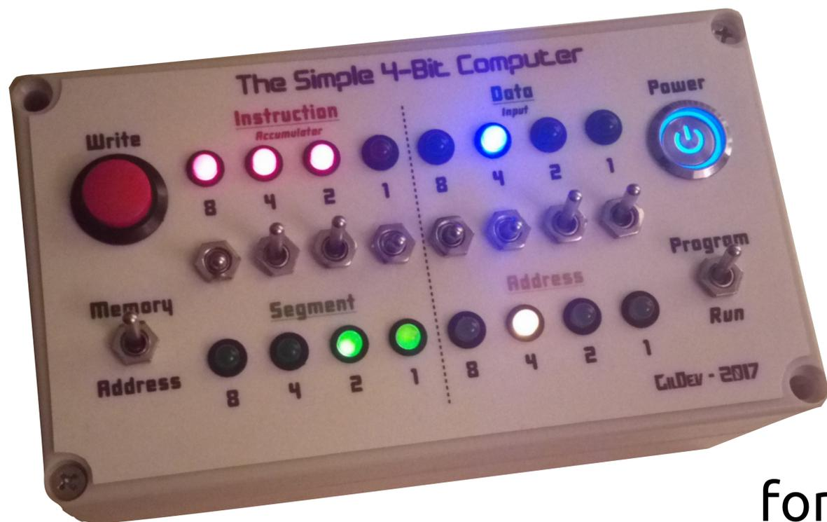
Programmé à l'aide de *LED* et d'*interrupteurs*, il est capable de reproduire le fonctionnement de divers ordinateurs de l'ancien temps.
